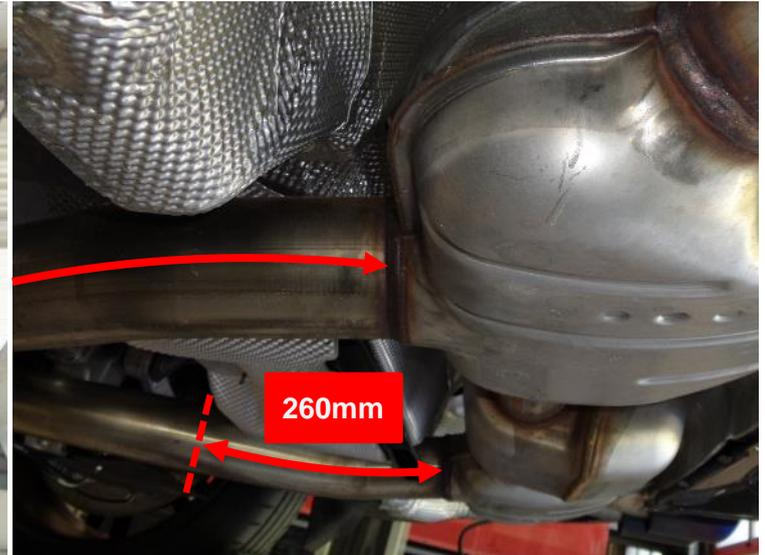
Die Aufhängungsgummis aushängen, die Aktuatoren abschließen und den serienmäßigen Endschalldämpfer abnehmen.
